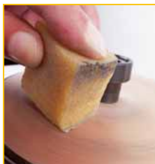
Um die Lebensdauer der Schleifbeläge zu verlängern, werden sie mit dem mitgelieferten Kreppwürfel gereinigt
