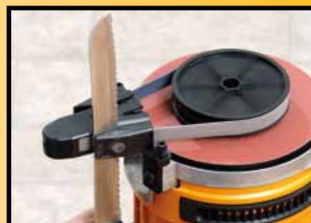
Messer-Schärfereinrichtung Art.:52702 (auch für Messer mit Wellenschliff)
