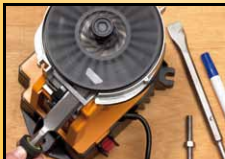
25° Standard Freiwinkel Auflage für Stechbeitel.
