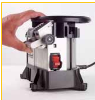
Durch einfaches Anheben der Zuführung wird der Schleifwinkel jeweils in 5°-Schritten verändert und gerastet
