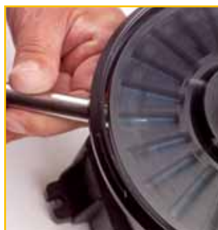
Da die zu schleifende Fläche gut zu sehen ist, können auch gerundete Schneiden risikolos frei Hand geschliffen werden
